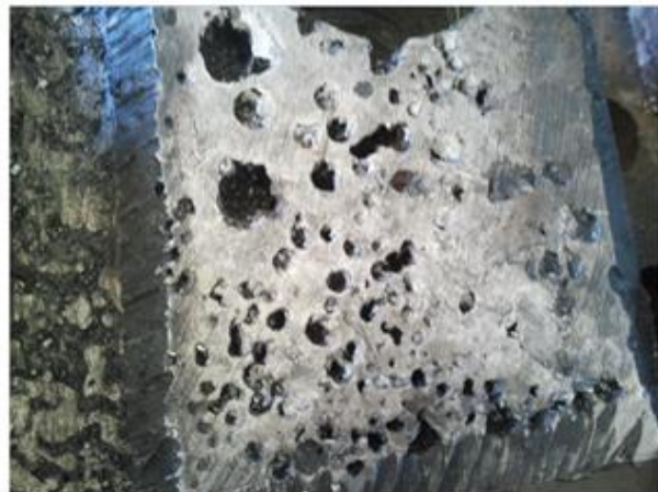
(d) Blow holes on plate 9
