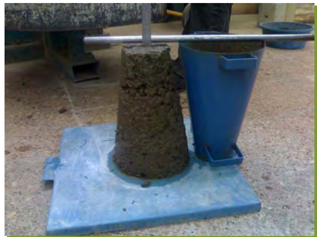
Fig. A.J-30 Slump for SFRC
