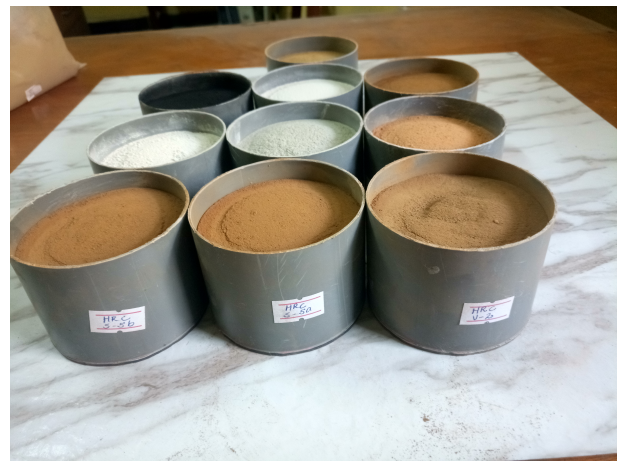
(d) Prepared samples for NaI(Tl) detector
