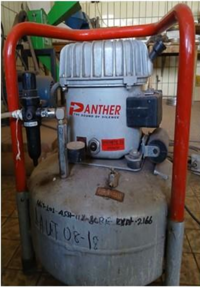
G. Air compressor
