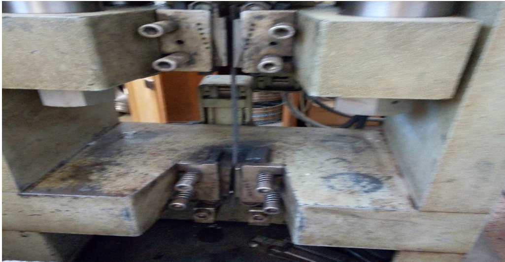
Figure 3-6: Longitudinal bar test set up
