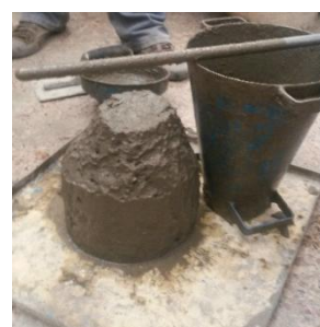
b) Slump test
