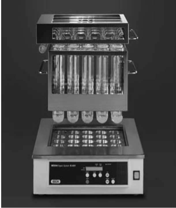
e) COD digester
