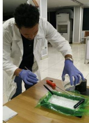
(d) Applying epoxy resin
