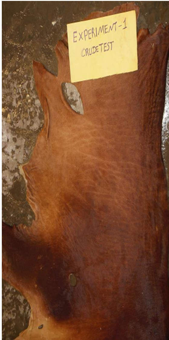
Fig.4.13a Cow hide before unhairing
