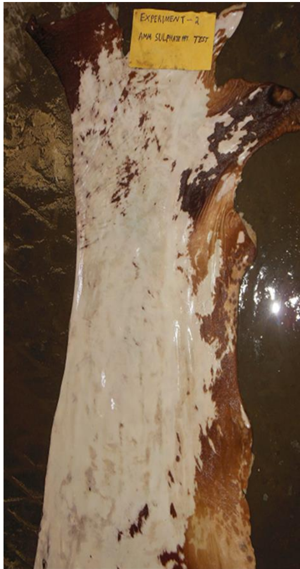
Fig.4.11b Cow hide after unhairing
