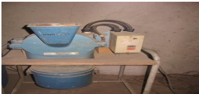
A: Grinding mill machine
